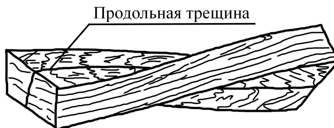
Рис. 29. Характер разрушения деревянного образца при кручении.
