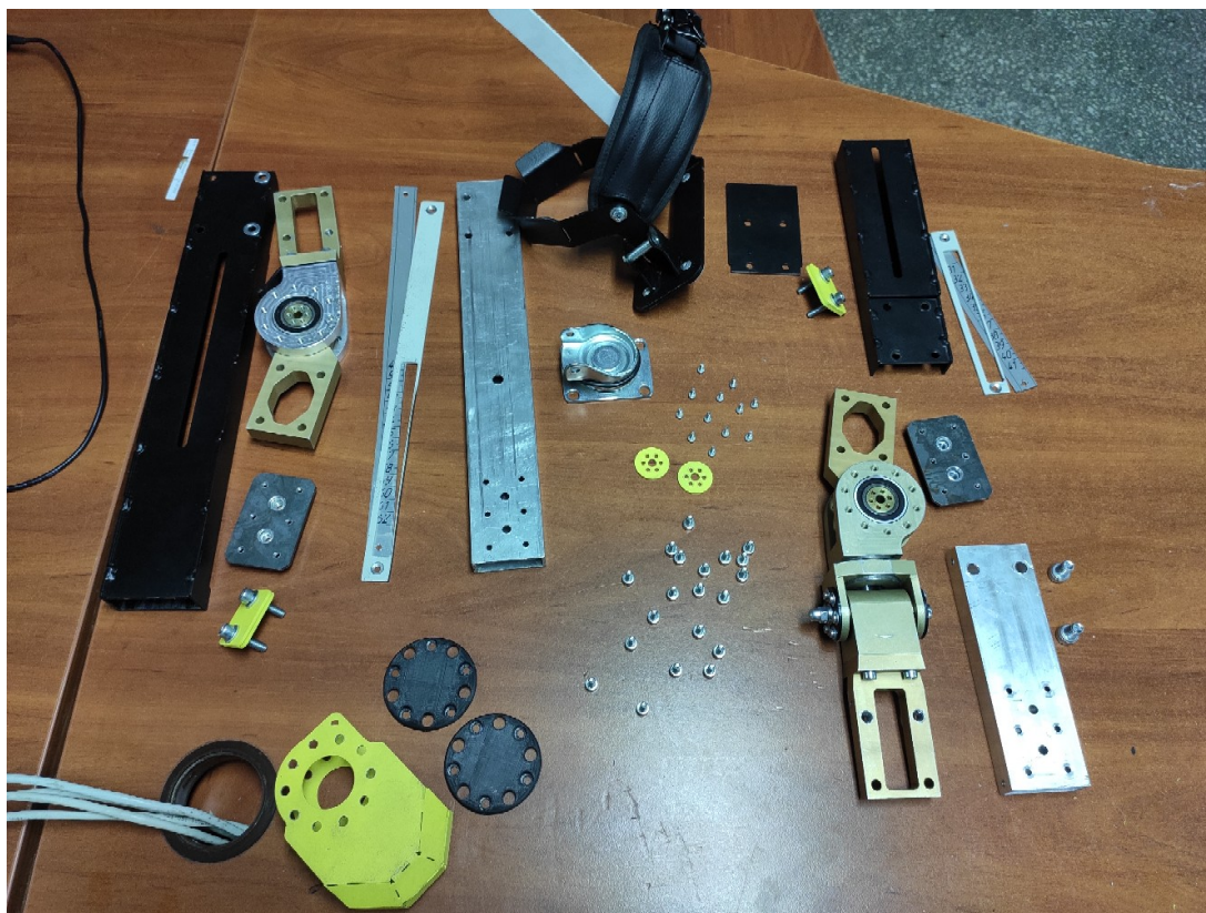
Рисунок 1.14 – Разобранная нижняя конечность экзоскелета
