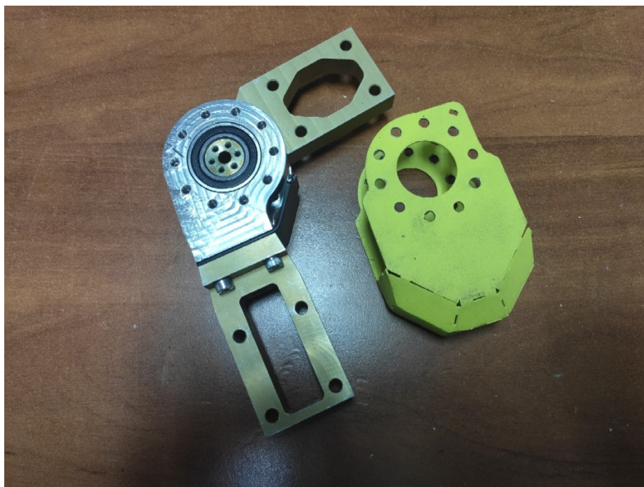
Рисунок 1.10 – Отделение колена от коленного шарнира
