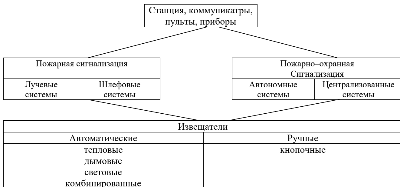
Рисунок 1 – Классификация систем пожарной и пожарно-охранной сигнализации
