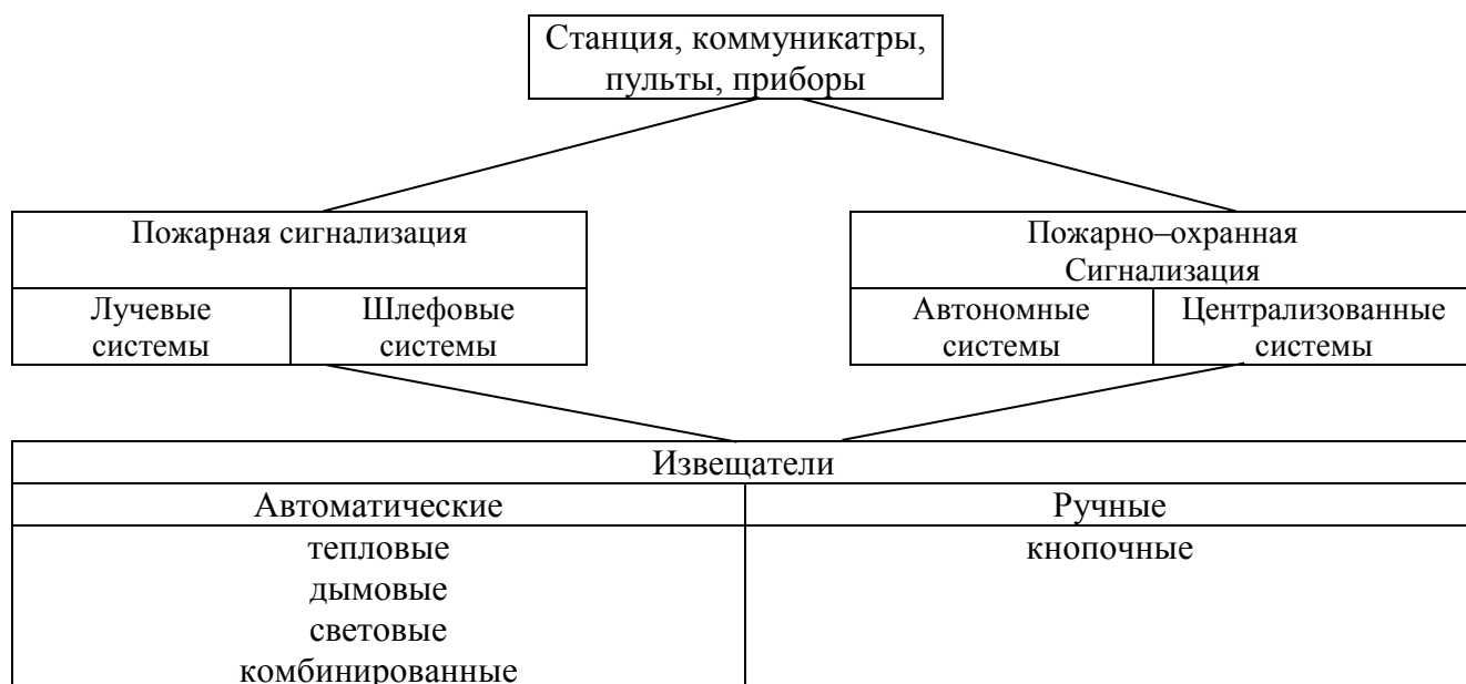
Рисунок 1 – Классификация систем пожарной и пожарно-охранной сигнализации
