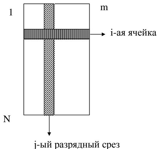
Рис. 1 Формирование ячейки и разрядного среза памяти.
