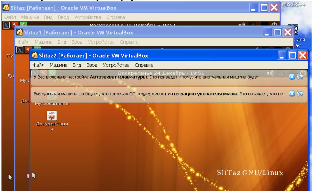
С помощью `ifconfig` поднимаем и настраиваем интерфейсы на новых машинах и два новых интерфейса на старой. Для настройки командой `su` даём терминалу права администратора. Второй машине даём адрес `192.168.2.2`.
