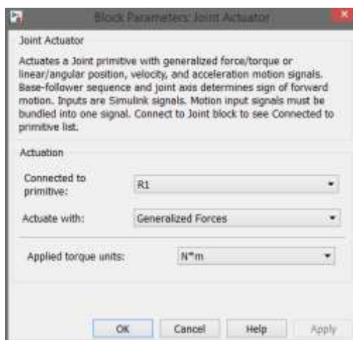
Рис. 1.19 Настройки блока Joint Actuator
