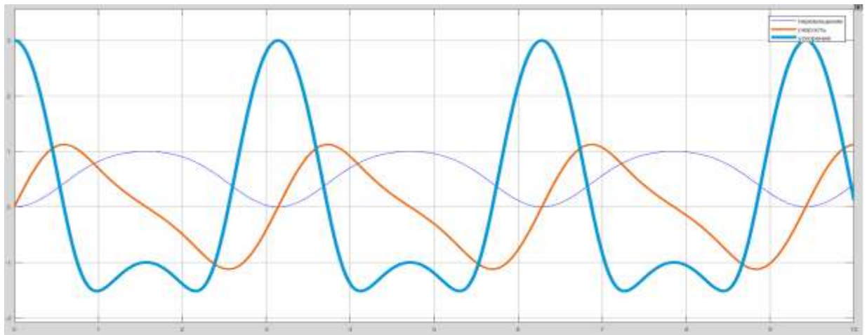
Рис. 4.16 Графики перемещения, скорости, ускорения ползуна
