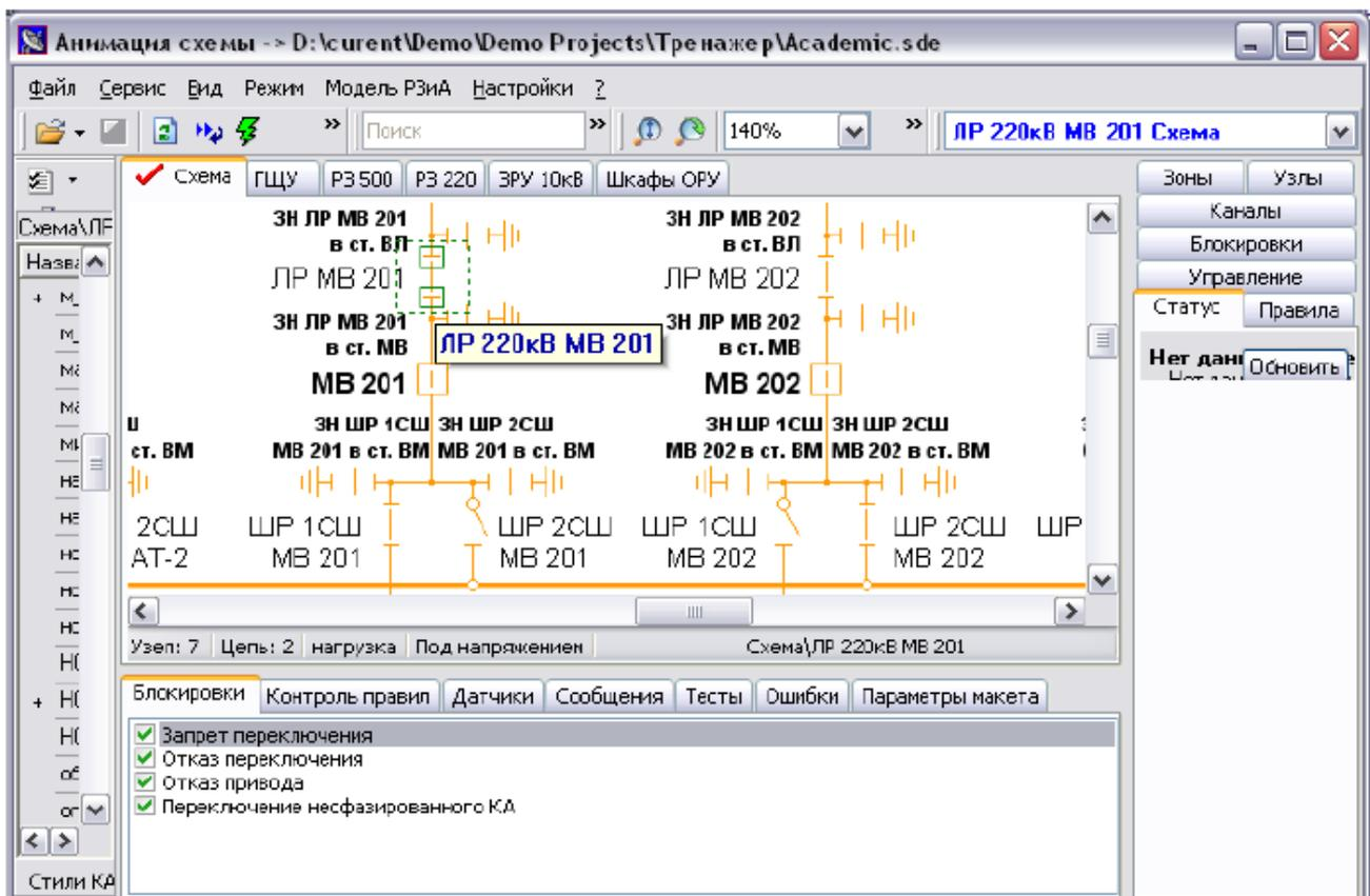
Рисунок 4.5. Набор predetermined блокировок для разъединителя
