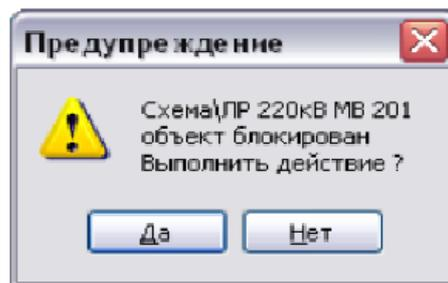
Рисунок 4.7. Предупреждение в результате действия блокировки «Запрет переключения»
