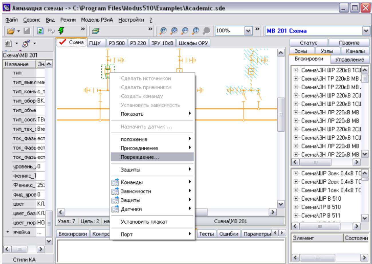
Рисунок 5.1. Моделирование повреждения схемы средствами контекстного меню
