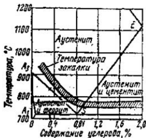
Рисунок 20. Оптимальные температуры нагрева для закалки доэвтектоидных и заэвтектоидных углеродистых сталей
