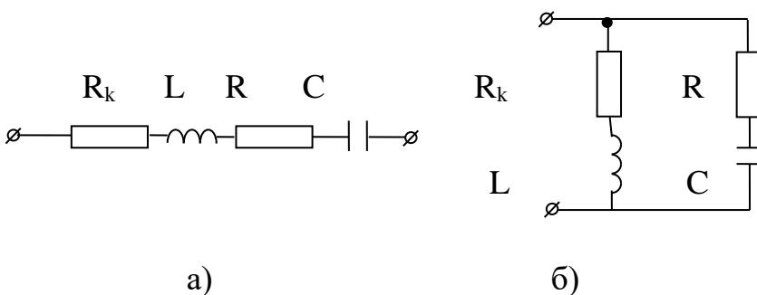
Рис. 2.3. Последовательная и параллельная цепь.
