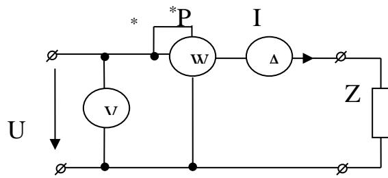
Рис. 2.2. Схема рабочей цепи
