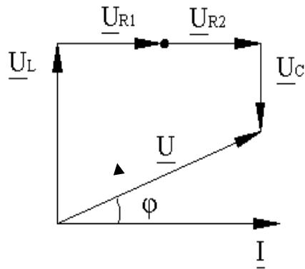
Рис. 1.8. Векторная диаграмма напряжений последовательной цепи.
