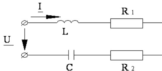
Рис. 1.7. Последовательная цепь переменного тока.
