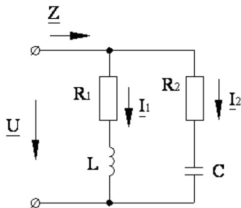
Рис.1.9. Параллельная цепь переменного тока.
