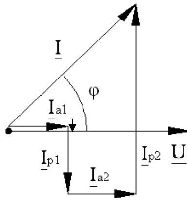
Рис.1.10. Векторная диаграмма токов параллельного соединения.
