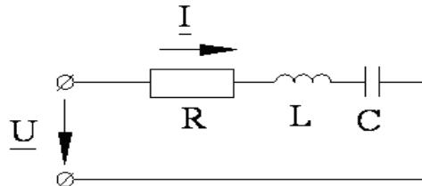
Рис. 1.4. Схема к расчету цепи символическим методом.
