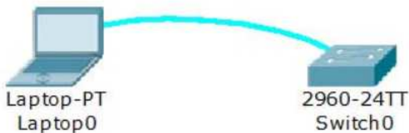
Рисунок 2.3 – Подключение по консольному кабелю
