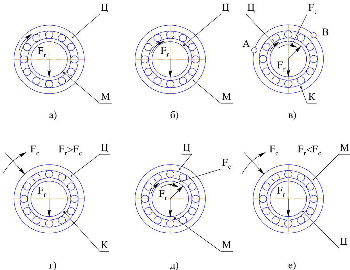
Рисунок 2.2 Виды нагружения колец подшипников качения
