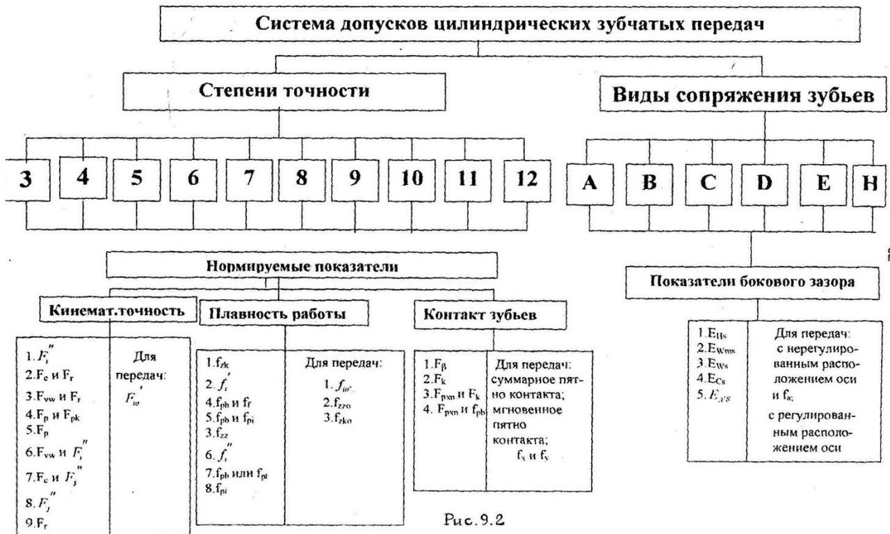
Рисунок 2.8 Система допусков зубчатых передач
