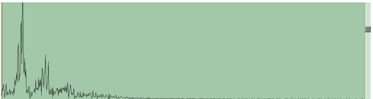
Рисунок 2.4 – Амплитудный спектр Фурье фрагмента фотоплетизмограммы (3000 отсчетов, частота дискретизации 100 Гц)
