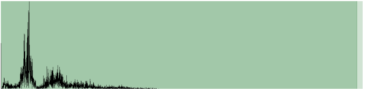
Рисунок 2.3 – Амплитудный спектр Фурье фрагмента фотоплетизмограммы (30000 отсчетов, частота дискретизации 100 Гц)
