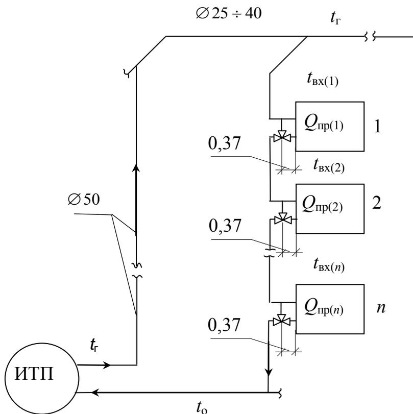
Рис. 3. Расчетная схема стояка
