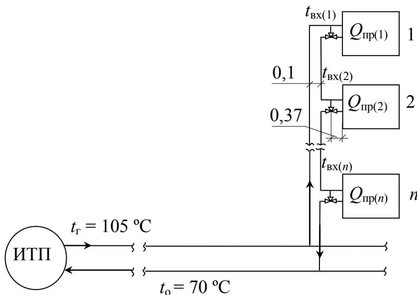
Рис. 4. Расчетная схема стояка
