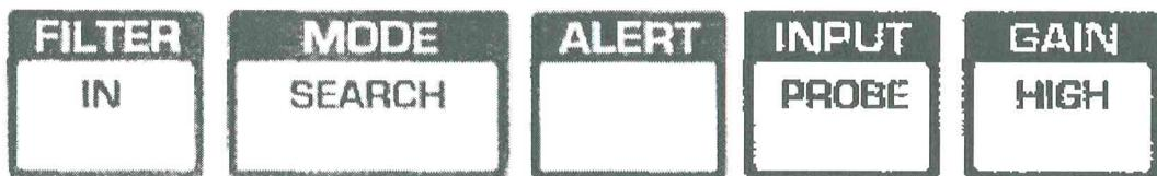
2. Проверьте калибровку счетчика. На дисплее должно быть 2 или 3 сегмента при высокой мощности (HIGH GAIN).
