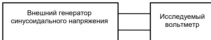
Рисунок 5 – Структурная схема измерения погрешности вольтметра.
