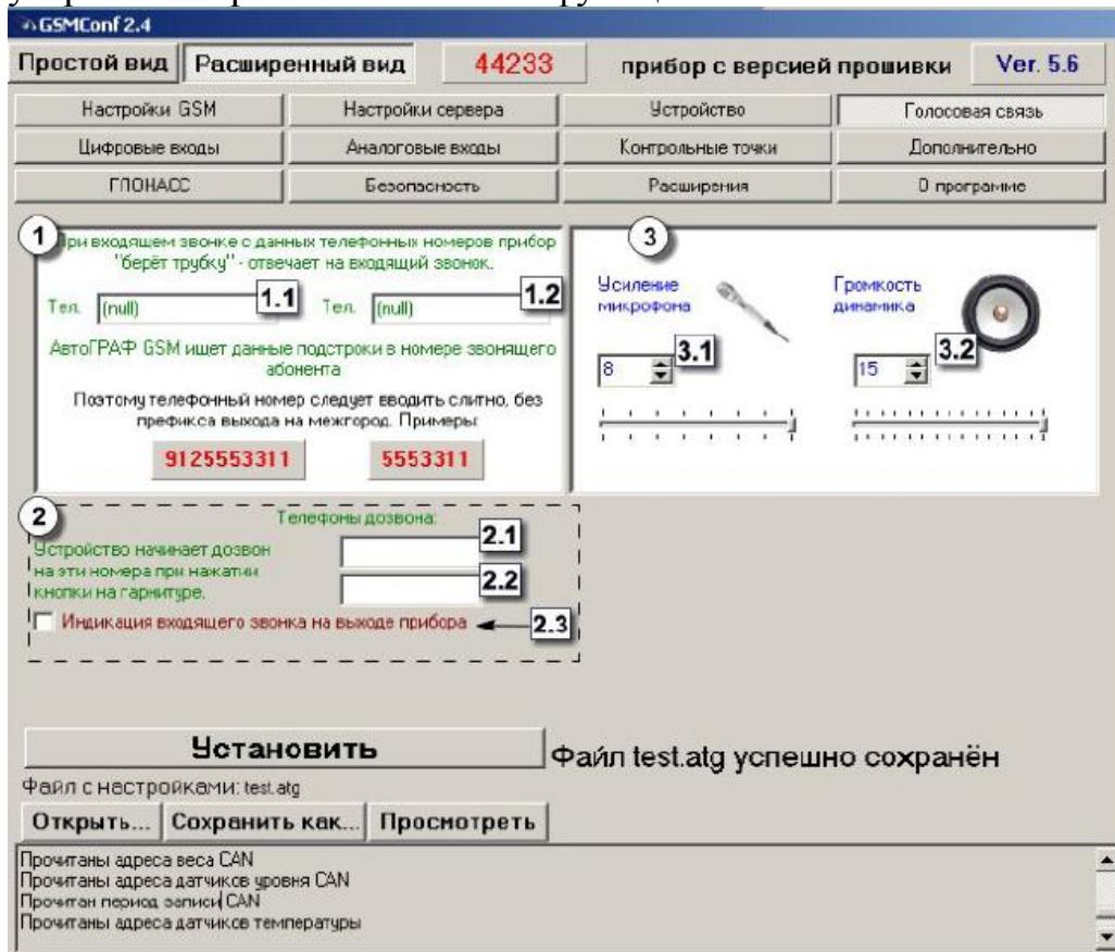
**Телефонные номера автоподнятия** – при входящем звонке с телефонных номеров, указанных в этих полях, устройство будет автоматически принимать звонок («поднимать трубку»). Номера следует вводить слитно, без префикса выхода на межгород. Автоматический приём входящего звонка происходит, если строка телефонного номера звонящего абонента содержит в себе подстроку первого либо второго телефонного номера.
