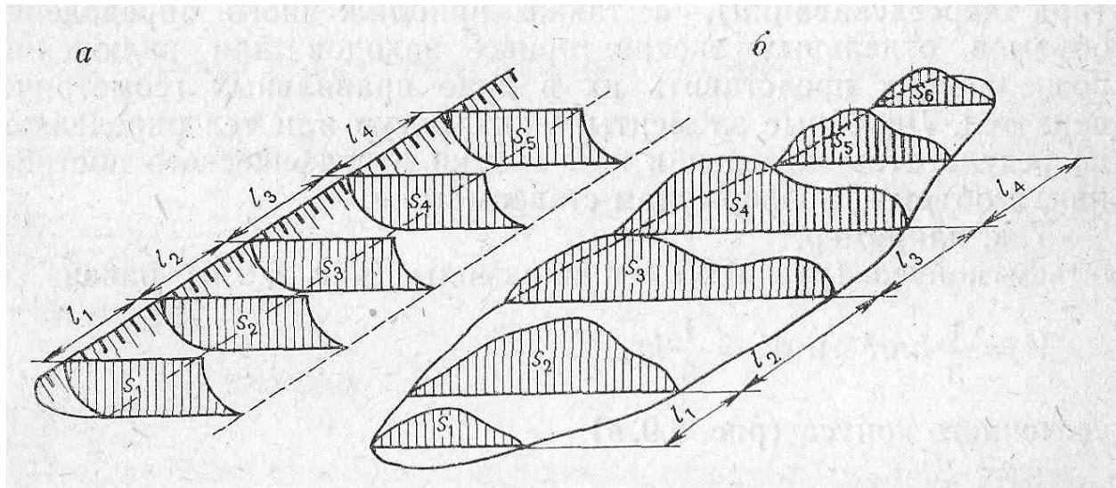
Учет объемов вынутых горных пород способом вертикальных сечений применим в том случае, если определяемый блок имеет сравнительно правильную вытянутую форму. Подсчет объемов ведут по поперечным вертикальным разрезам с равными расстояниями между сечениями.
