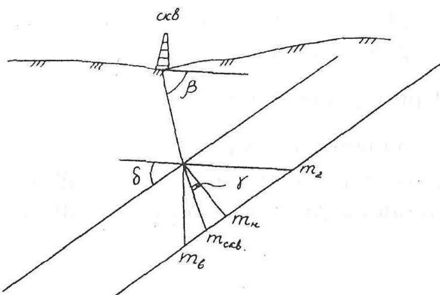
Глубина залегания  $h_3$  полезного ископаемого - расстояние по вертикали от земной поверхности до висячего бока залежи.:
