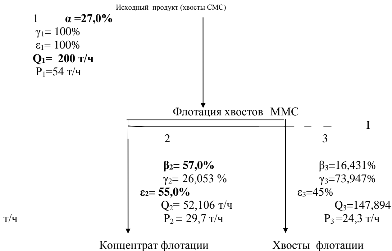
Рис. 1 Принципиальная схема флотации хвостов мокрой магнитной сепарации.
