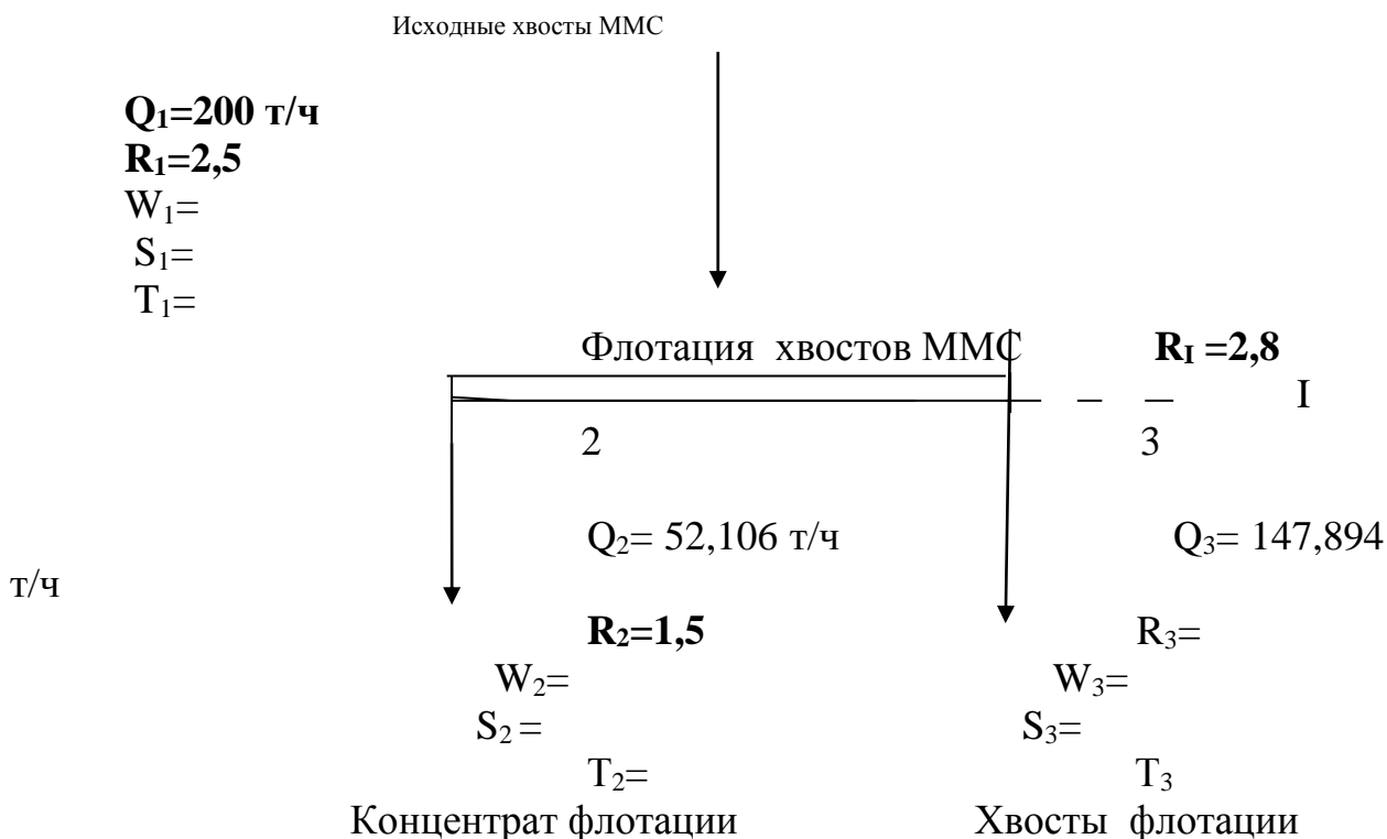
Рис. 1 Принципиальная водно-шламовая схема флотации хвостов ММС
