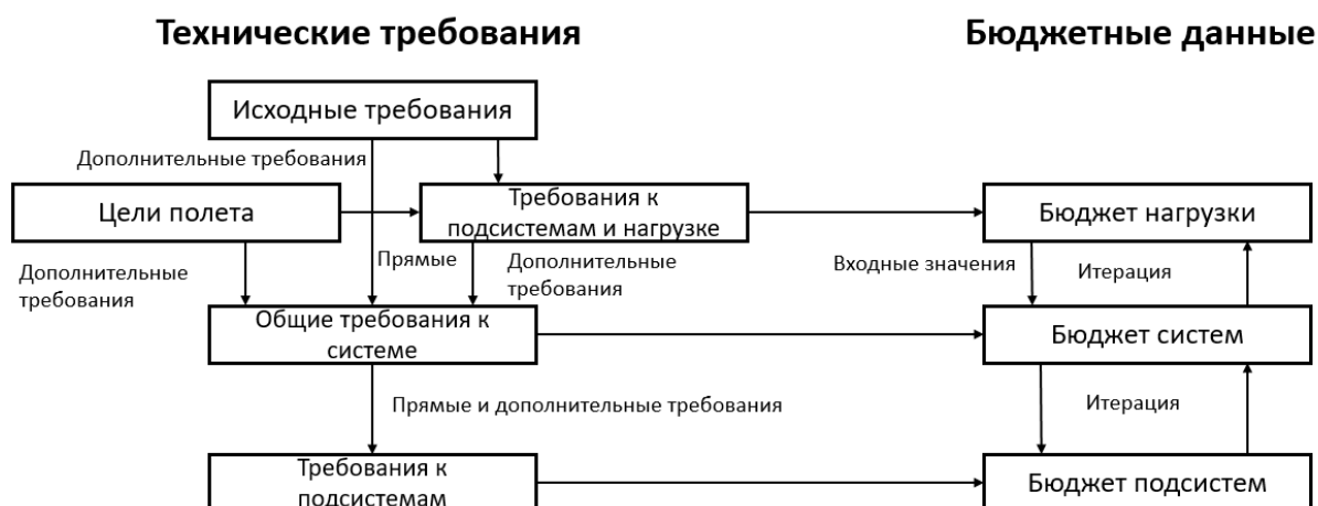
Рисунок 2 – Расширение и перевод исходных требований в спецификации
