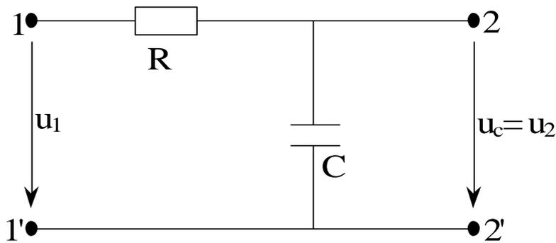
Рис. 3.1. RC-цепь как четырехполюсник
