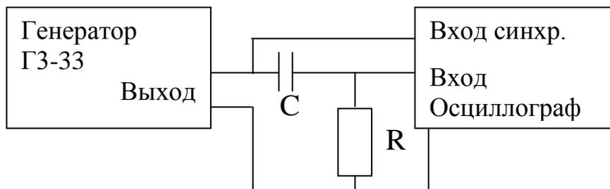
Рис. 5.2. Схема для исследования дифференцирующей RC-цепи
