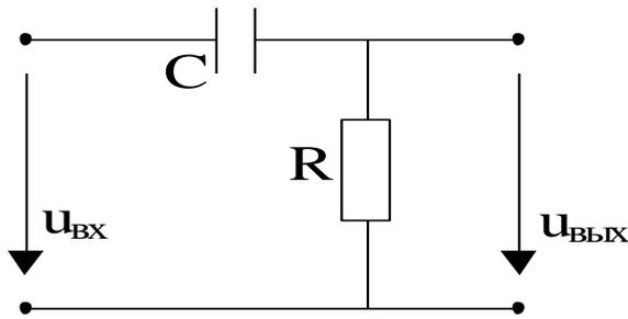
Рис. 3.2. Дифференцирующая RC-цепь
