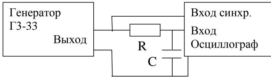
Рис. 5.1. Схема для исследования интегрирующей RC-цепи
