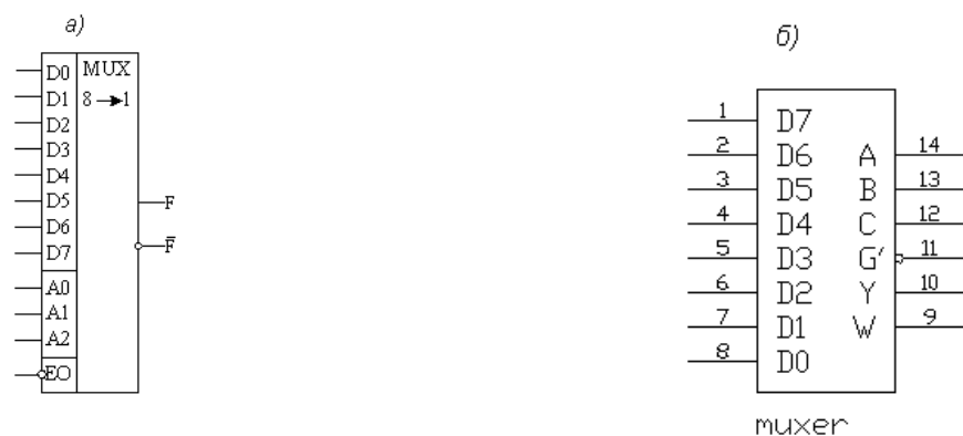
Рис. 1. Условные графические обозначения мультиплексора; по ГОСТ (а) и в системе DIN (б)
