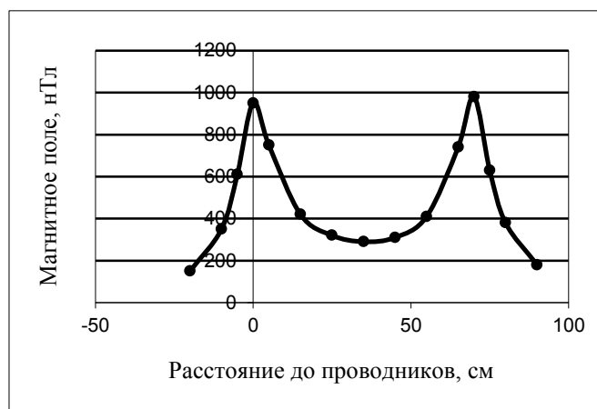
Рис.1-5 Расстояние между проводниками 70 см. Ток в проводниках 0,2 А. Приемная антенна расположена над проводниками на высоте 2 см и перемещалась перпендикулярно проводникам. Точки максимума поля – места расположения проводников.
