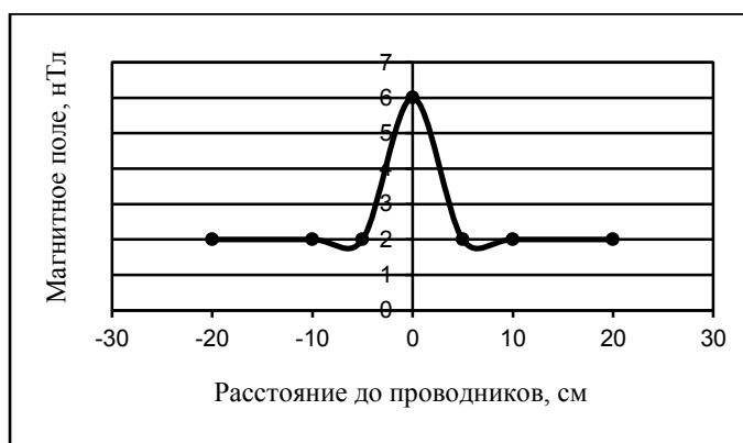
Рис.1-2. Два проводника скручены. Ток в проводниках 0,2 А. Приемная антенна расположена над проводниками на высоте 2 см и перемещалась перпендикулярно проводникам. 0 – место расположения проводников.
