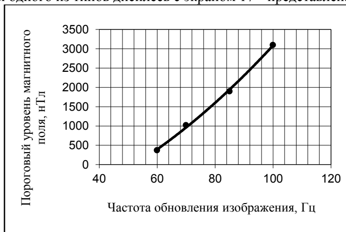
Рис.1-15. Зависимость порогового уровня магнитного поля от частоты обновления изображения для одного из типов дисплеев с экраном 17".
