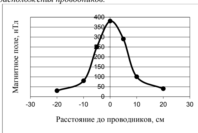
Рис.1-4. Расстояние между проводниками 3 см. Ток в проводниках 0,2 А. Приемная антенна расположена над проводниками на высоте 2 см и перемещалась перпендикулярно проводникам. 0 – середина расстояния между проводниками.
