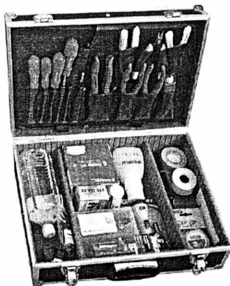
Рис.5. Типовой набор инструментов для разделки ОК и ОВ.
