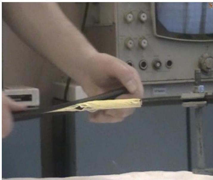
Рисунок 6 – Съём наружной оболочки
