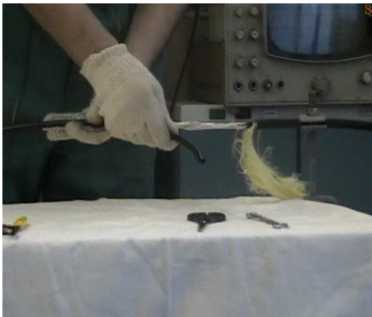
Рисунок 7 – Съём внутренней оболочки
