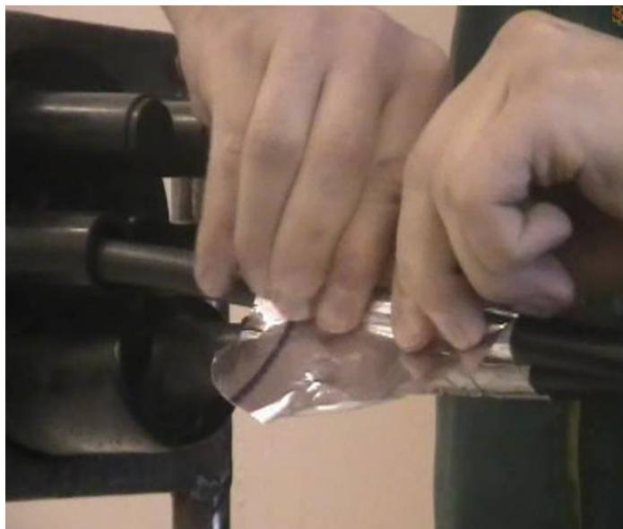
Рисунок 16 - Защита кабеля алюминиевой фольгой
