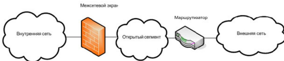
Рис. 5.1b - подключение межсетевого экрана с двумя сетевыми интерфейсами при выделении открытого сегмента внутренней сети
