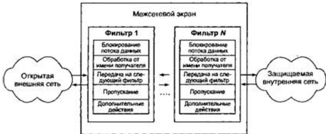
Рис. 3.1. Структура межсетевого экрана
