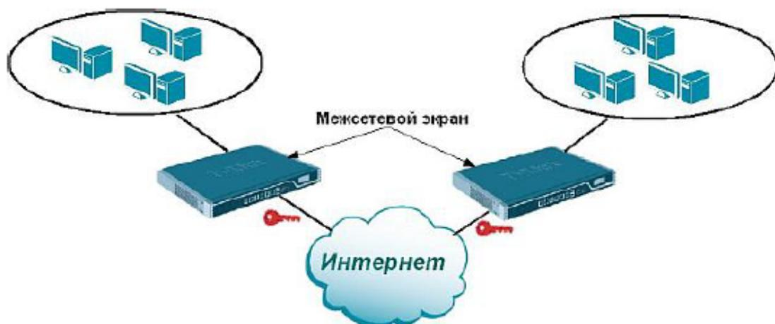
Рис. 6.4. VPN-соединение типа сеть-сеть
