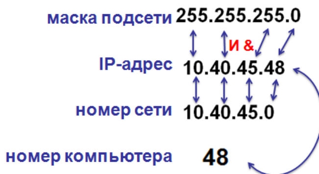
Рис. 2.3. Расчет номера сети по IP-адресу и маске сети
