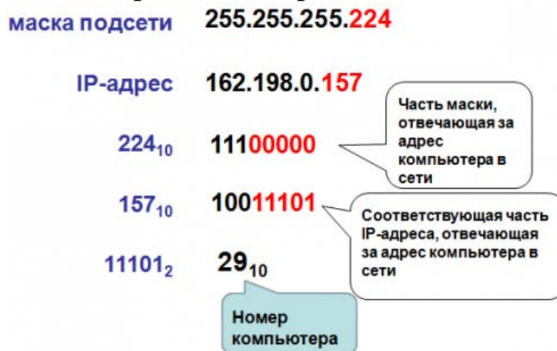
Рис. 2.4. Расчет номера компьютера в сети
