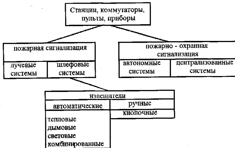
Рис.1 Классификация систем пожарной и пожарно-охранной сигнализации
