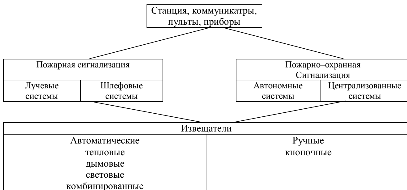
Рисунок 1 – Классификация систем пожарной и пожарно-охранной сигнализации
