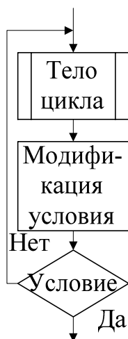
Рис.35. Цикл Do - Loop Until
