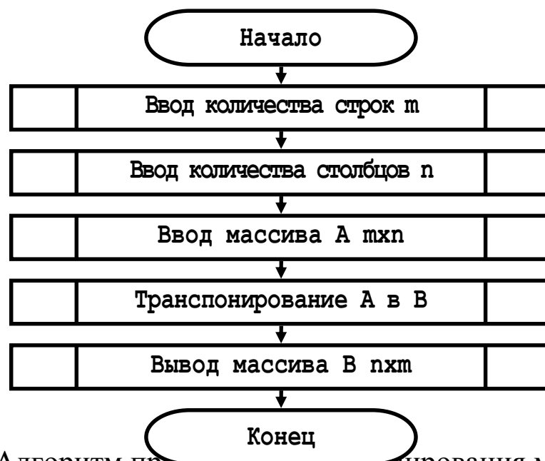
Рисунок .42. Алгоритм программы транспонирования матрицы.
