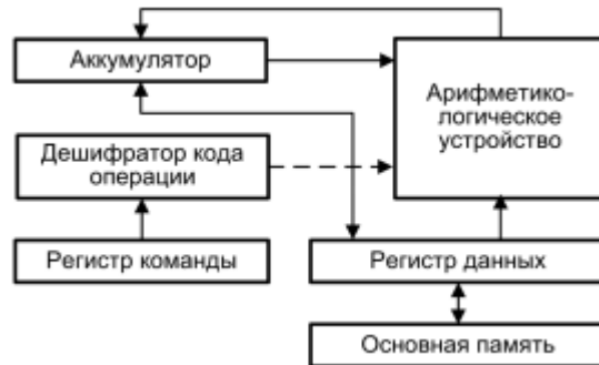
Рисунок 4.2 – Архитектура аккумуляторной машины
