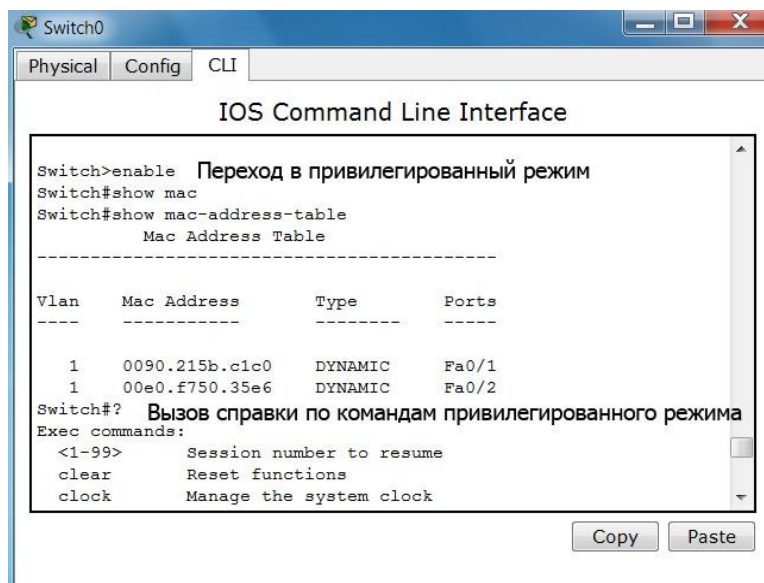
Рис. 12. Переход в привилегированный режим и просмотр таблицы MAC-адресов коммутатора командами Cisco IOS
