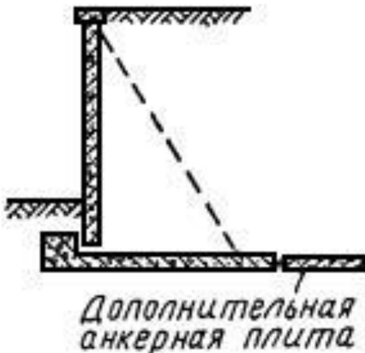
Рис.5. Сборная конструкция подпорной стены с дополнительной монолитной анкерной плитой
