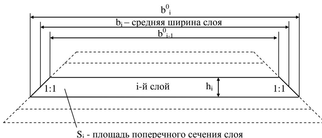
Рис. 2. Основные геометрические параметры слоя дорожной одежды
