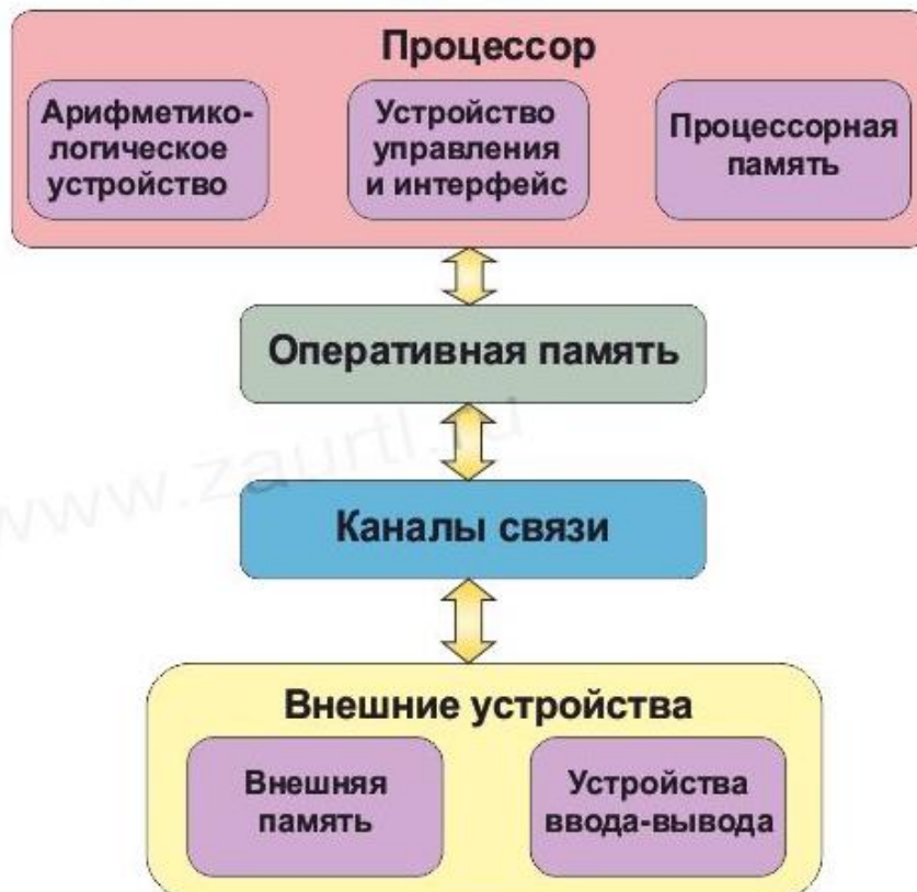
Рисунок 1 – Упрощенная структурная схема ЭВМ
