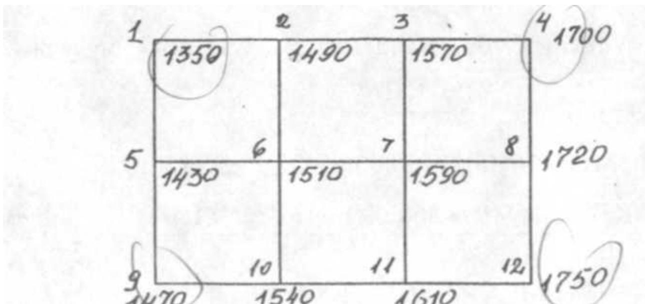
Отметка репера —  $H_{Rp} = 18,700$ . Отсчет по рейке на репере —  $a = 1,300$ .
