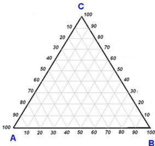
Рисунок 2 – Треугольник Гибса-Розебома для изображения состава трехкомпонентных систем
