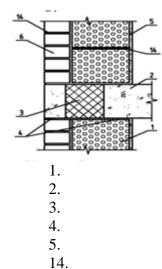
4.11 Приведите правильное соответствие элементов двуслойной стены: а) кладка из блоков, б) плита перекрытия, в) термовкладыш, г) деформационный шов, д) штукатурка, е) оцинкованная сетка, ж) кирпичная кладка в ½ кирпича, з) невентилируемый воздушный зазор, и) диффузионная пленка.
