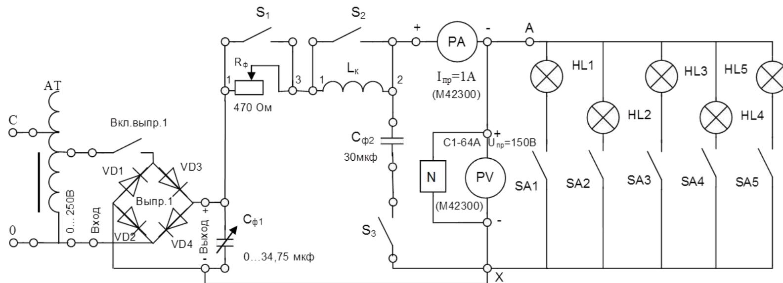
Рис. 4.1. Электрическая схема исследования выпрямителя
