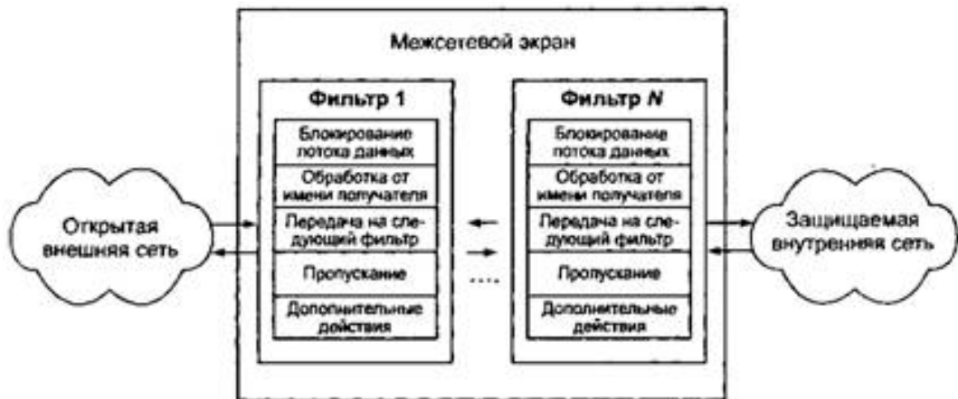
Рис. 3.1. Структура межсетевого экрана
