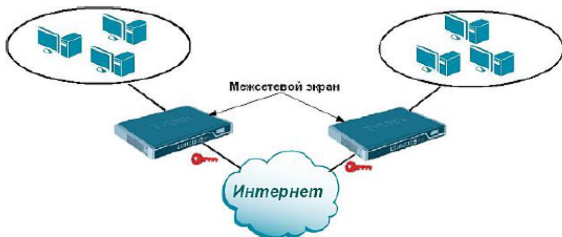
Рис. 6.4. VPN-соединение типа сеть-сеть
