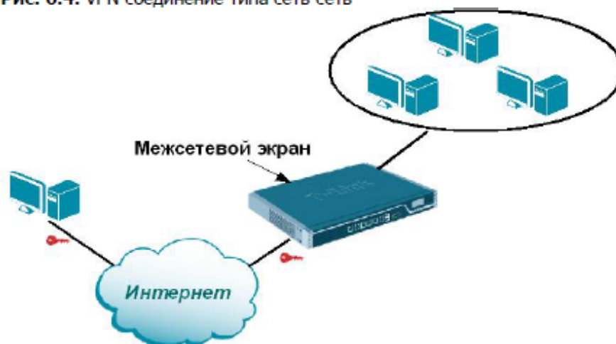
Рис. 6.4. VPN-соединение типа сеть-сеть
