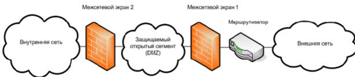
Рис. 5.1d - подключение двух межсетевых экранов для защиты внутренней сети и ее открытого сегмента
