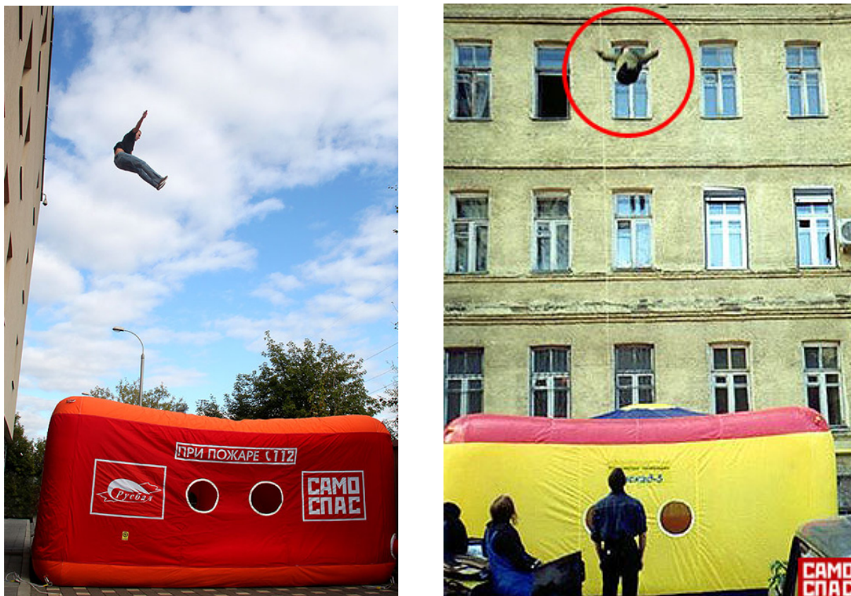
Рисунок 7 – Прыжковое устройство Каскад-5 («Куб Жизни»)
