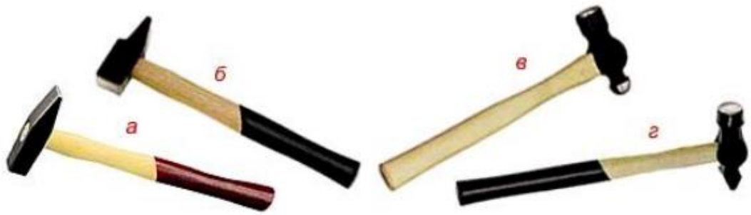
а – германский; б – французский; в – британский; г – американский Рисунок 4.9 – Типы молотков общего назначения
