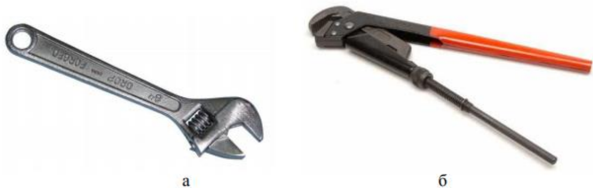
а – разводной, б – трубный Рисунок 4.5 – Регулируемые ключи
