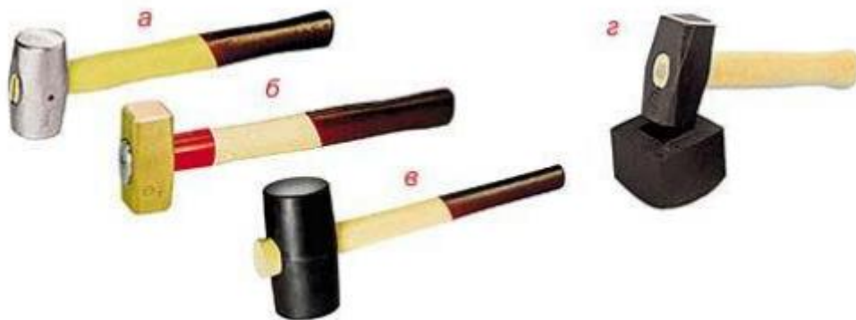
а – свинцовый молоток; б – медный молоток; в – резиновый молоток; г – резиновый наконечник (накостыльник) для кувалды
