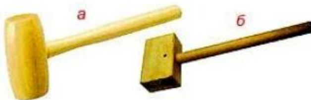
Рисунок 4.12 – Молотки из дерева (киянки) с круглой (а) и прямоугольной (б) головками
