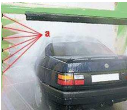
Рисунок 1.6 – Работа рамки с распылителями: а - распылители
