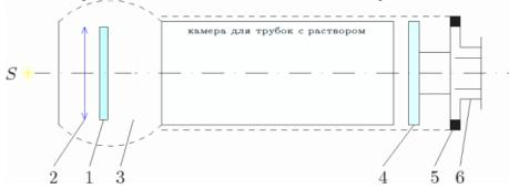
На рисунке изображена схема поляриметра, укажите названия частей прибора, соответствующих цифрам на рисунке Поляризационное устройство, состоит из поляризатора, осветительной линзы, кварцевой пластинки, Анализатора, фрикционера, муфты.
