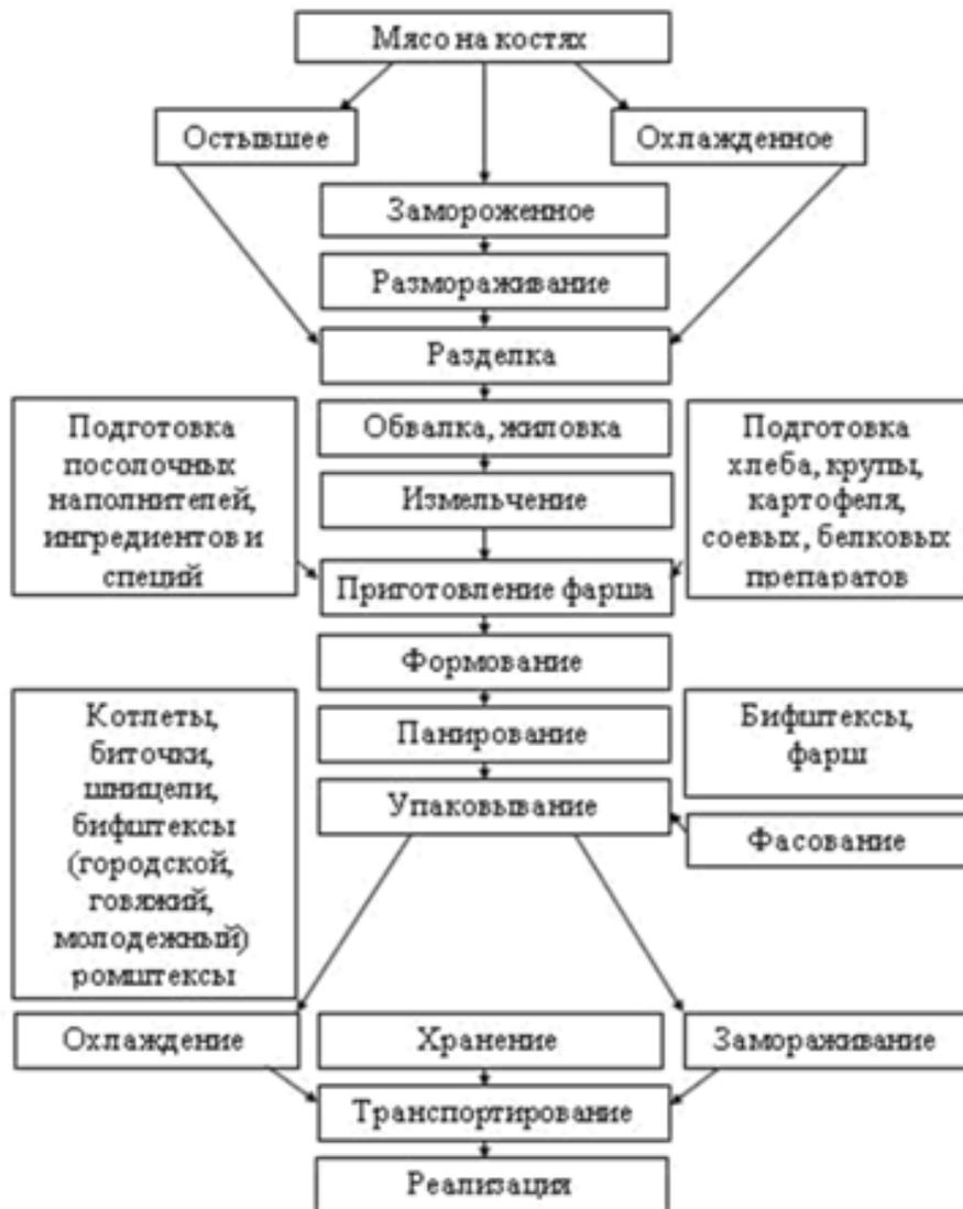
Рисунок 1 - Технологическая схема производства рубленых полуфабрикатов
