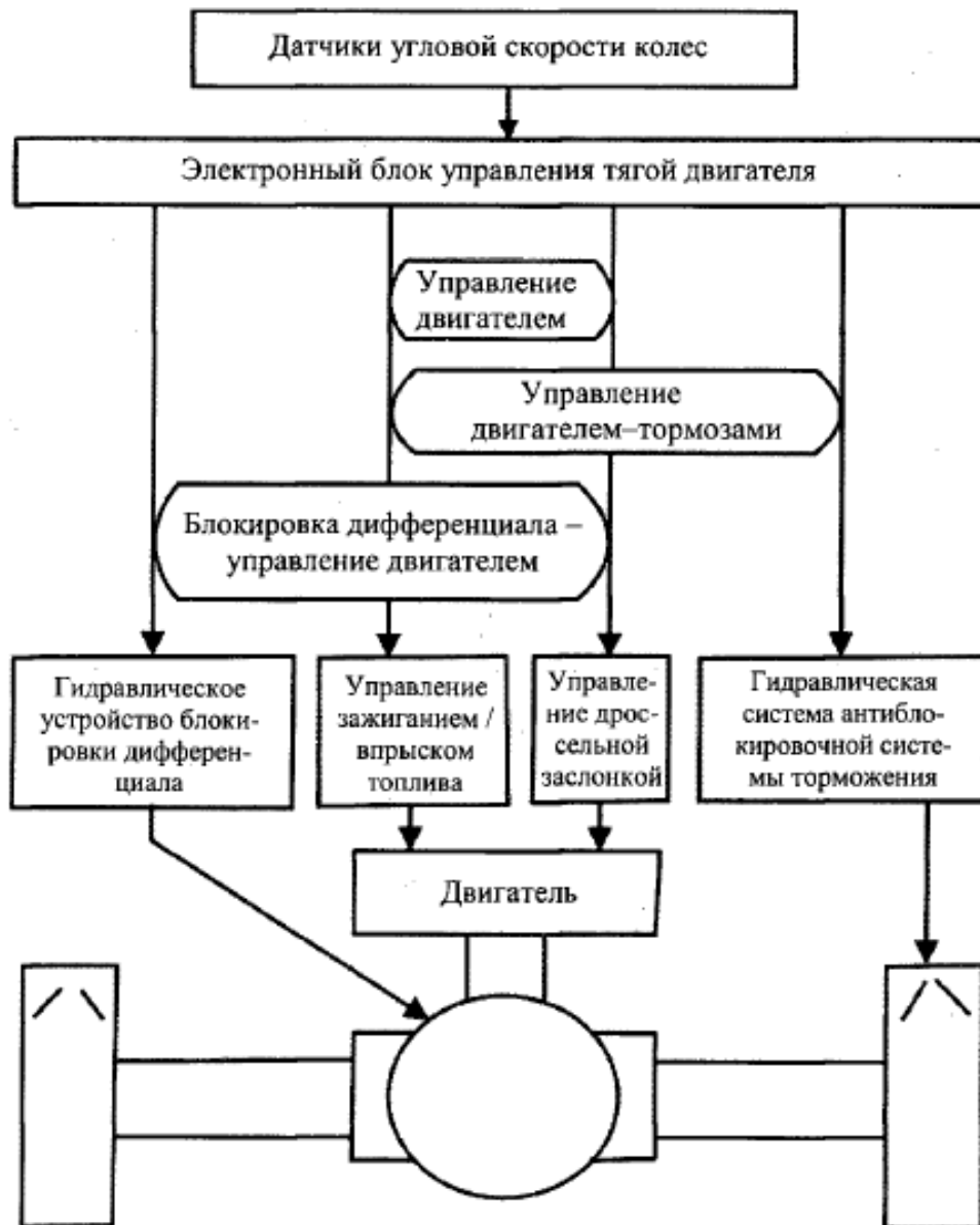
Рисунок 5 – Блок-схема вариантов противобуксовочной системы
