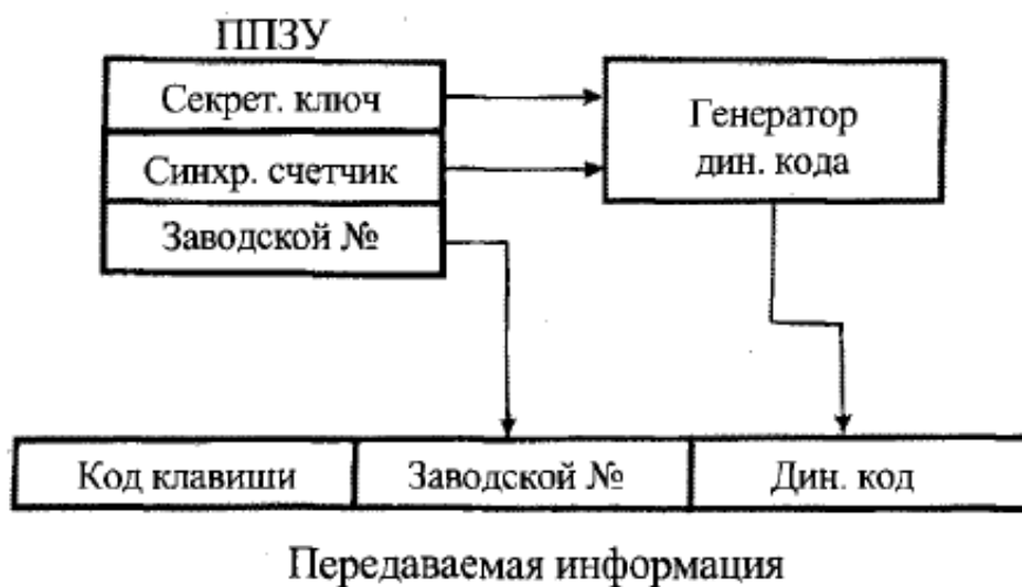
Рисунок 5.1 – Алгоритм работы передатчика
