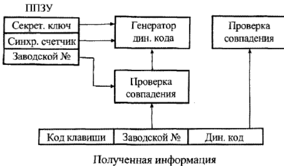
Рисунок 5.2 – Алгоритм работы приемника
