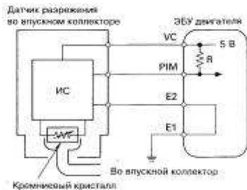
Рис. 1.6(а). Схема включения датчика абсолютного давления коллектора
