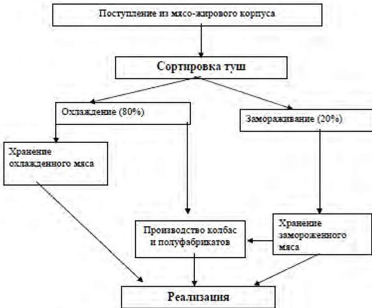
Рисунок 2. Схема холодильной обработки мясных туш при однофазном способе обработки
