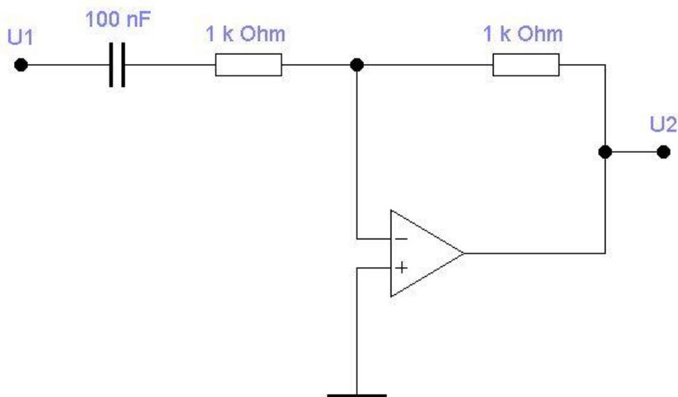
Рисунок 2 - Схема низкочастотного усилителя на ОУ в инвертирующем включении
