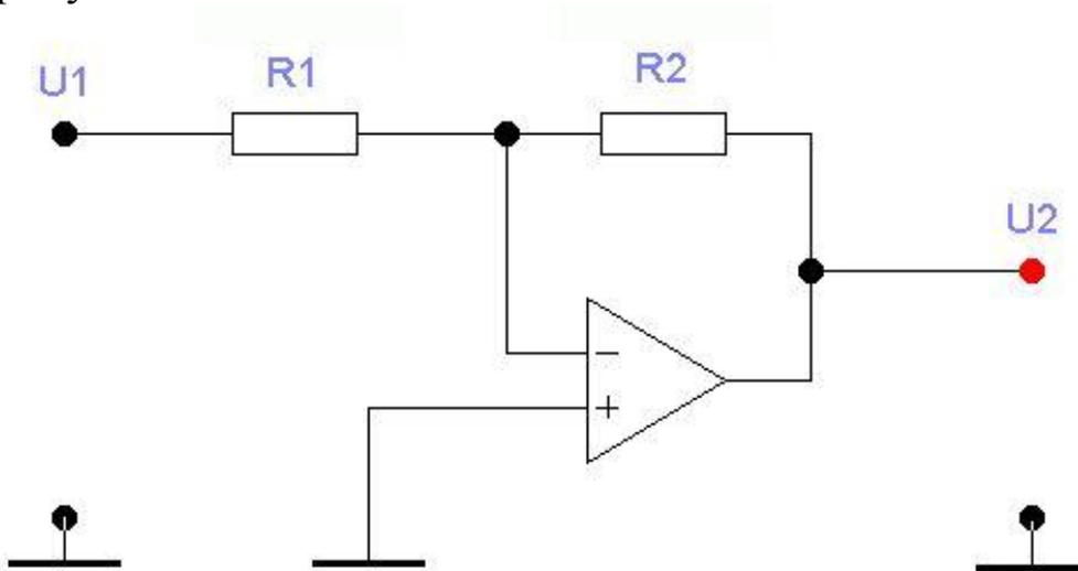
Рисунок 1 - Схема усилителя постоянного тока на ОУ в инвертирующем включении
