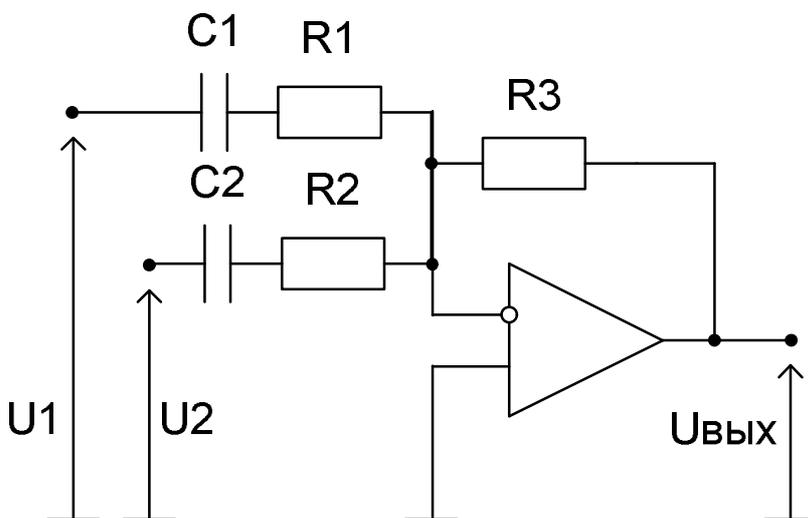
Рисунок 6 - Схема сумматора звуковых сигналов на ОУ
